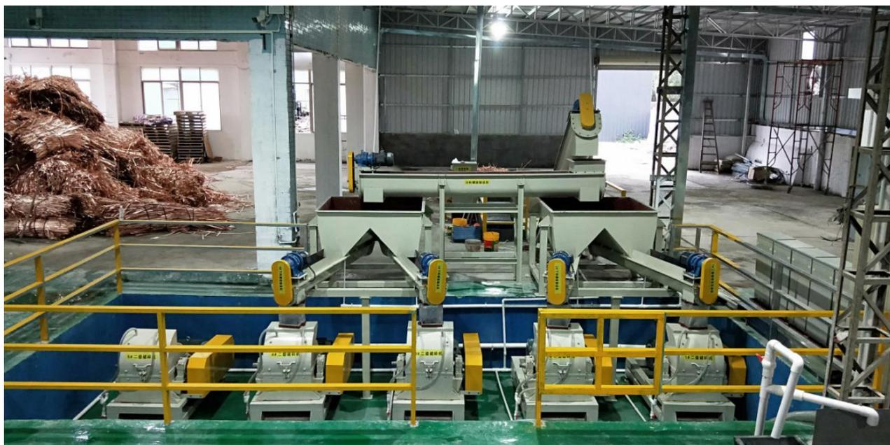
图 2.2-14 废电路板湿法分选工艺破碎机组装示意图
