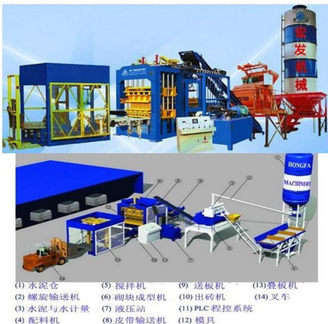
图 2.2-19 环保砖生产线设备连接示意图
